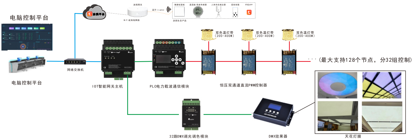
图① 平台软件+IOT网关主机+导轨式PLC总线通信模块+恒压双通道直流PWM控制器+DMX效果器
